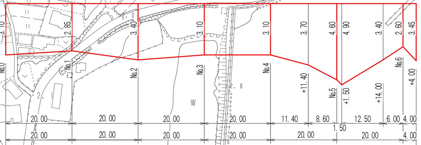
アスファルト 舗装工 再密Top13 t=4cm L=124.0m W=2.6~4.9m A=413m<sup>2</sup>
