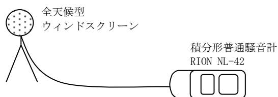
図 2-1-1 測定機器の構成例
